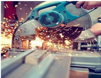
**Figura 11.** Corte con desprendimiento de viruta [11].
