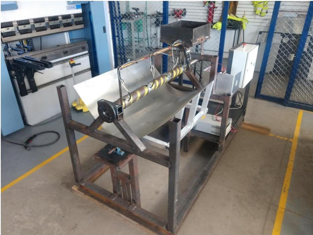
**Figura 36.** Vista completa de máquina extrusora con CCP integrado.
