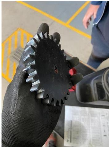
**Figura 29.** *Manufactura de engrane mediante corte por plasma.*
