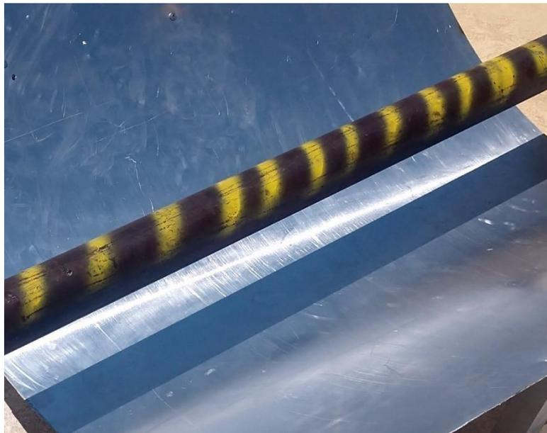
**Figura 44.** Pruebas preliminares de proyección de radiación solar sobre el cañón.
