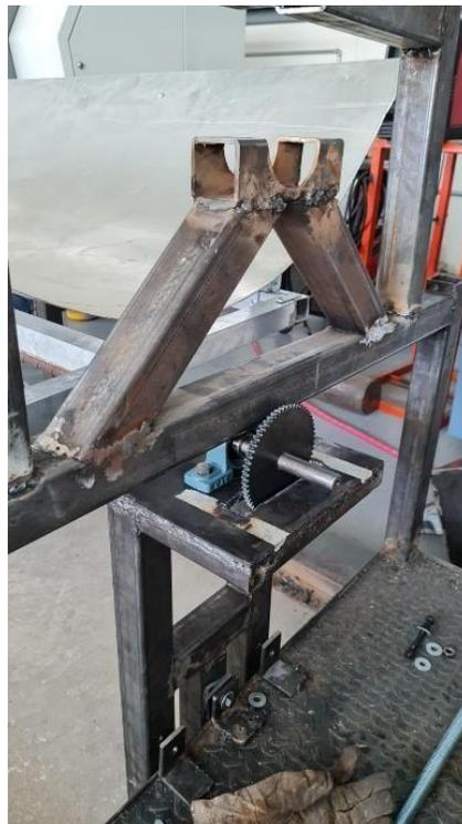
**Figura 37.** Sistema de engranes del CCP.
