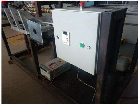
**Figura 33.** Gabinete de control de variador del sistema de transmisión de potencia.
