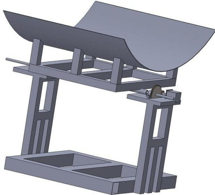
**Figura 23.** Vista completa del CCP con engranaje.
