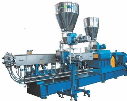
**Figura 7.** Máquina extrusora horizontal de doble husillo. [7]
