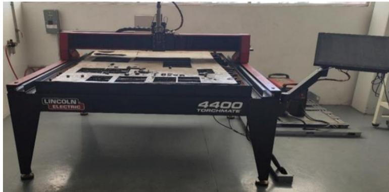
**Figura 15.** Máquina de plasma LINCOLN ELECTRIC 4400.
