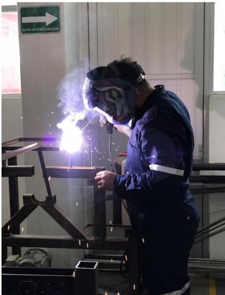
**Figura 9.** Soldadura MMA.
