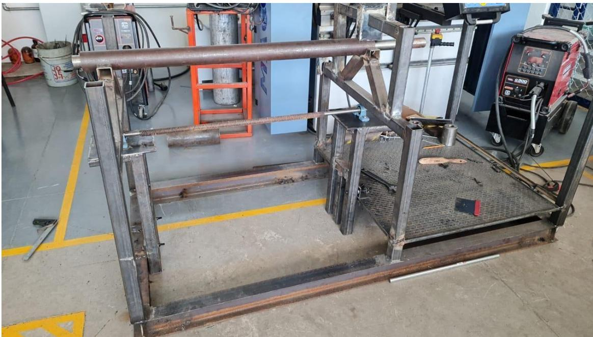
**Figura 32.** Estructura de soporte de máquina con cañón y porta CCP integrados.
