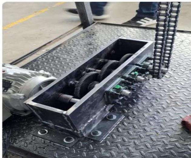
**Figura 35.** Caja de engranes del sistema de transmisión de potencia: vista lateral
